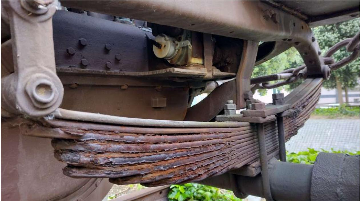
Montaje de las ballestas en conjunto con suspensiones verticales con el muelle de absorción.
