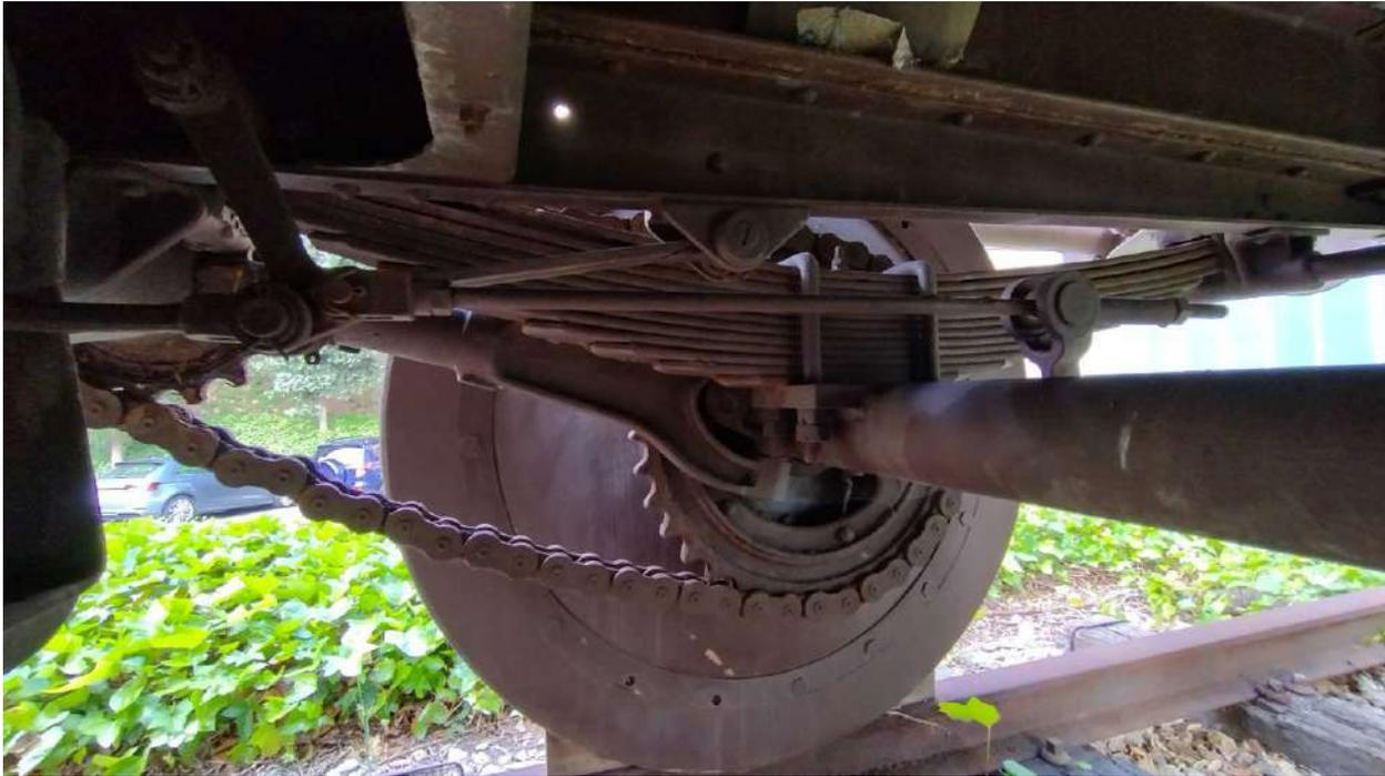
Sistema de transmisión con la transformación al eje de vía.
