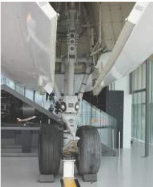
**Figura 3.** Tren de aterrizaje apoyado sobre soporte. Boeing 747 Lope de Vega. Fotografía: Archivo MUNCYT.
