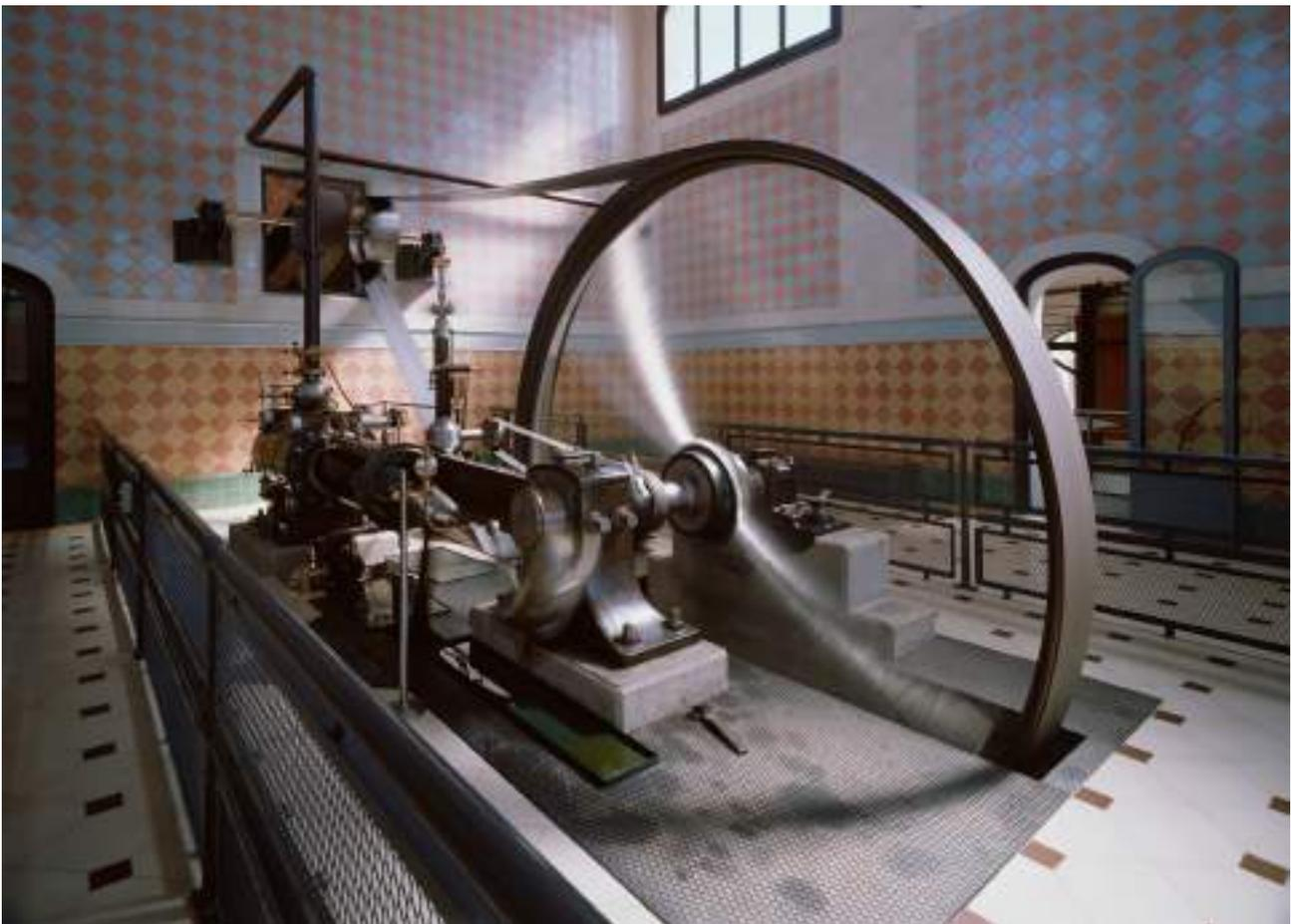
**Figura 3.** Máquina de vapor. Maquinista Terrestre y Marítima, modelo Compound (1898). Fotografía: Teresa Llordés. Archivo MNACTEC.
