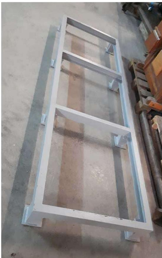
Soporte metálico del panel de control, realizado en taller.
