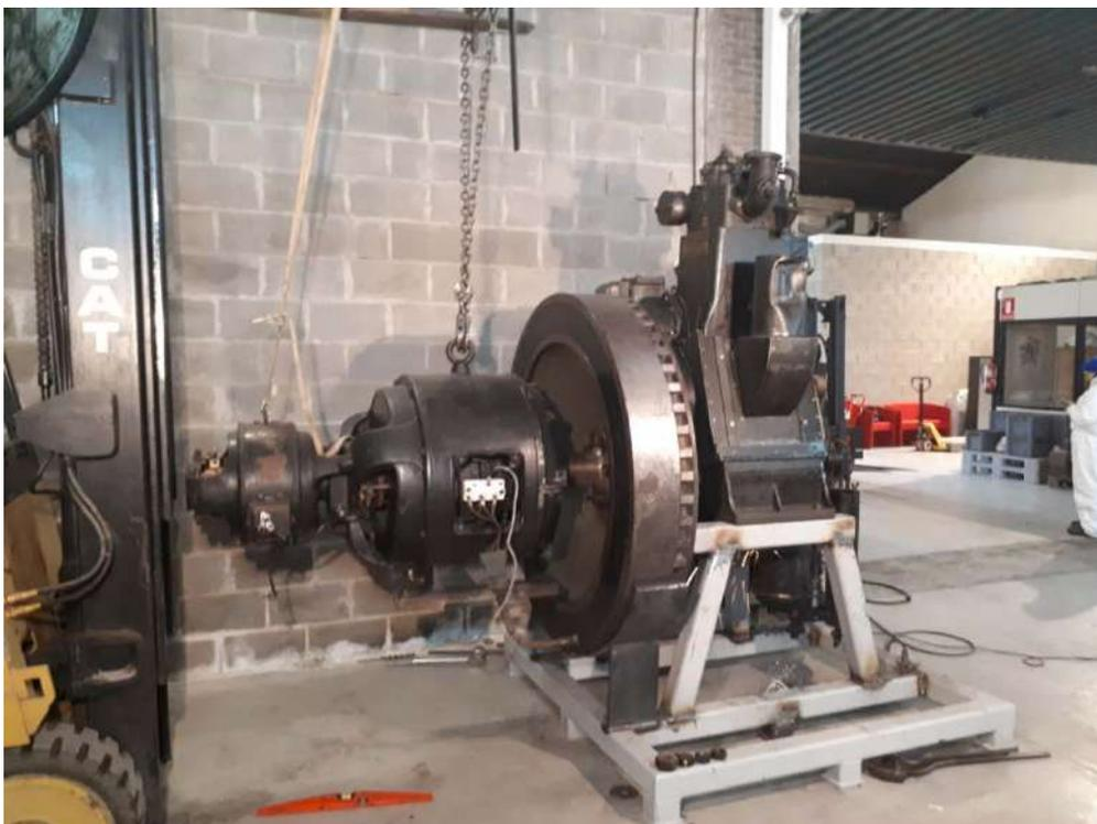
Montaje de las tres piezas a falta del soporte metálico del generador.
