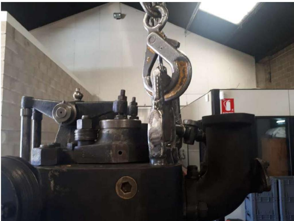
Elevación del bloque motor, previa instalación de casquillo de acero en espera de la trócola.
