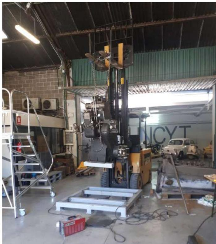
Elevación del bloque motor con toro mecánico.
