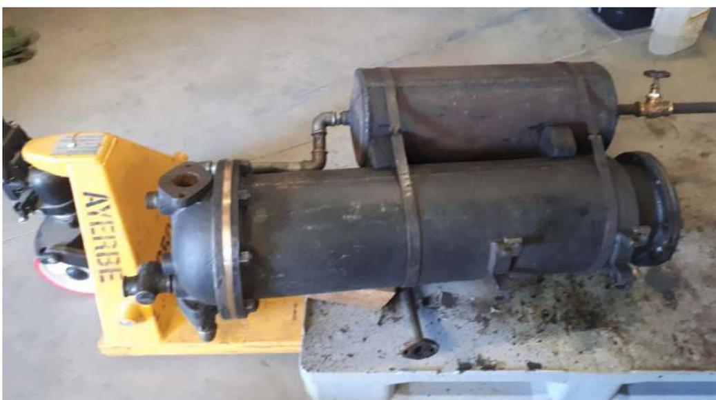
Desmontaje temporal de depósitos auxiliares, que impedían la manipulación en el montaje general del motor.
