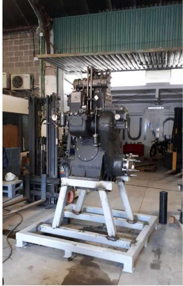
El bloque motor apoyado sobre su nueva estructura metálica.
