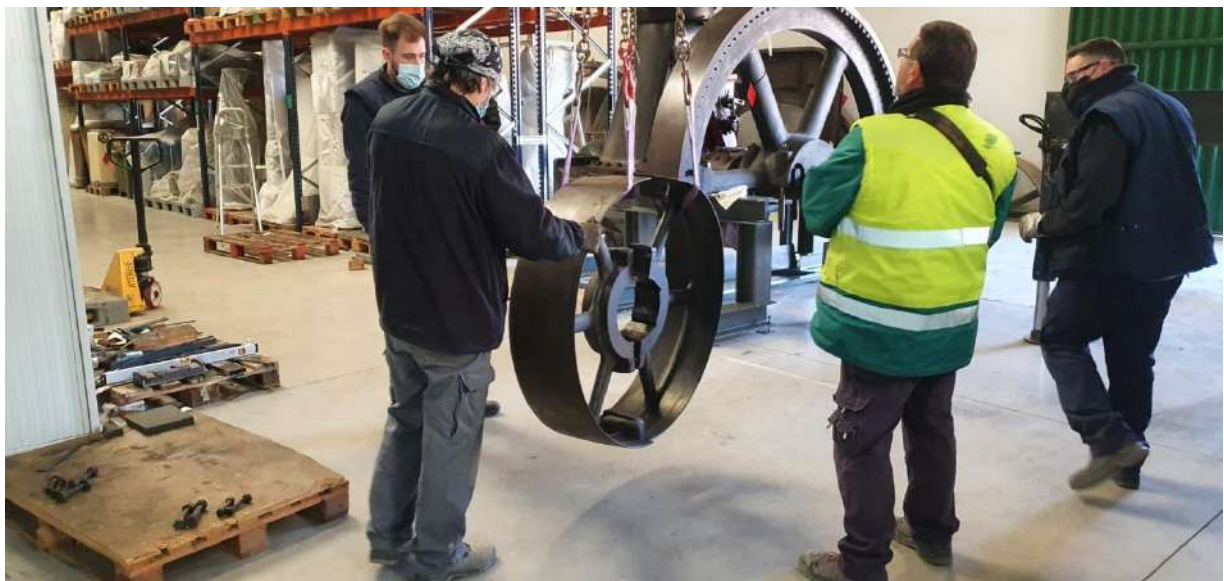
Montaje del volante pequeño compuesto por dos piezas, que se izaron a la vez y se depositaron sobre el eje del cigüeñal con posterior atornillado.
