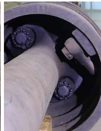
Aspectos de la biela principal, con los tornillos de anclaje para su manipulación. El cable de acero trenzado quedará en su interior por si fuera necesario desmontar el motor en un futuro.
