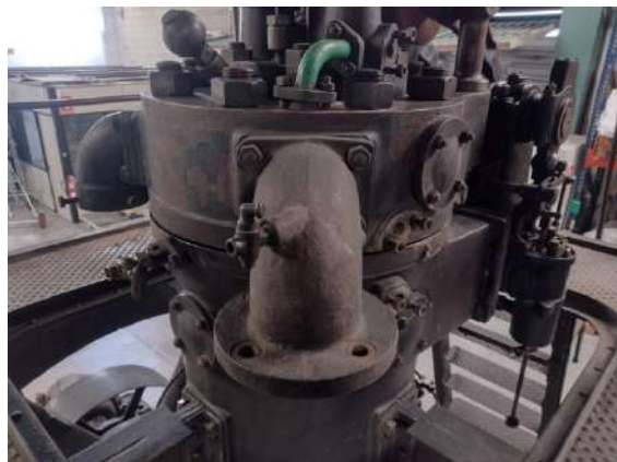
El árbol de levas es la parte más complicada en cuestión de mecánica. Al no plantearse la posibilidad de desmontarlo en parte, no podemos conocer los engranajes internos de la cámara superior
