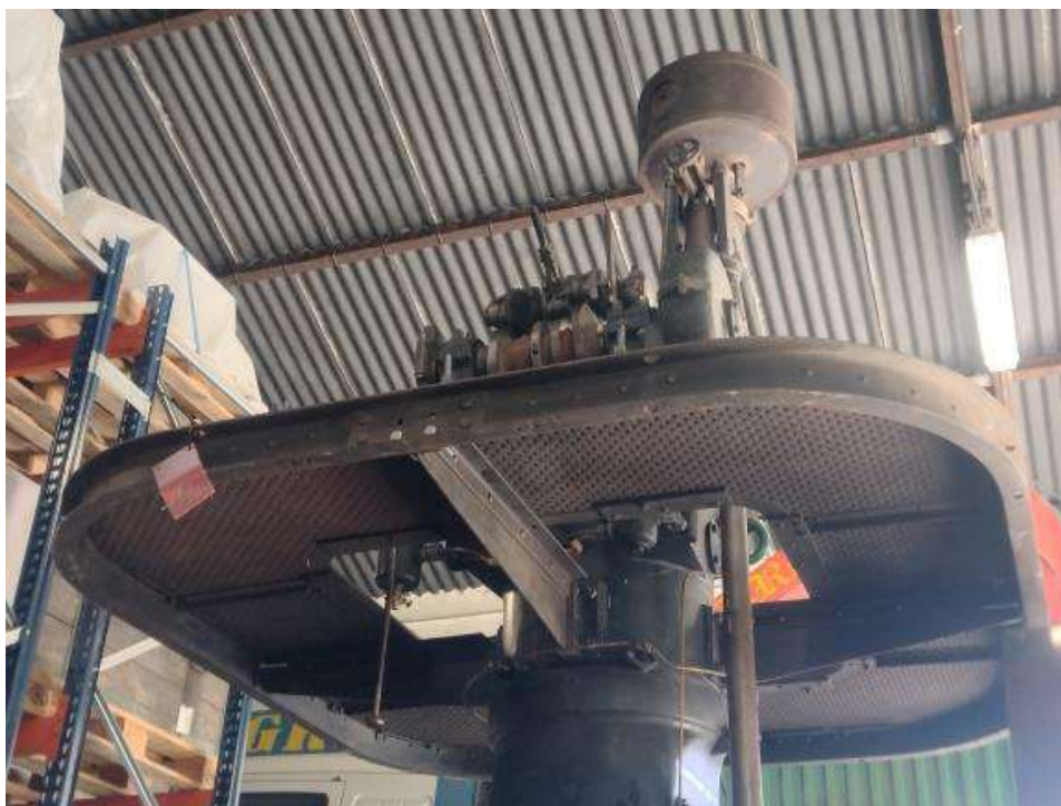
Montaje de la plataforma sobre los cuatro brazos anclados al bloque motor.
