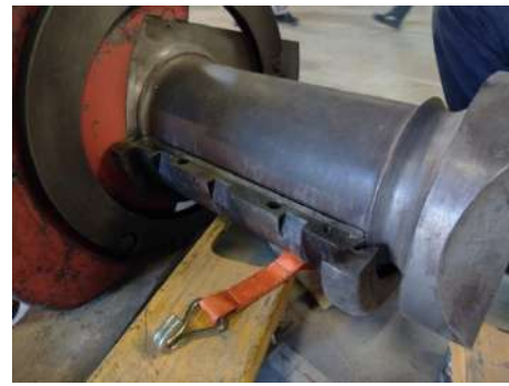
Anillo del cigüeñal que se combina con las dos piezas del cojinete C. Es necesario montar y asegurar los cojinetes al instalar el cigüeñal en la bañera de cárter.
