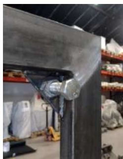
Bancada de asiento del cárter y detalle del método de nivelado para corregir las irregularidades del suelo Tamaño de la bancada del cárter: 200 x 174 x 67 cm
