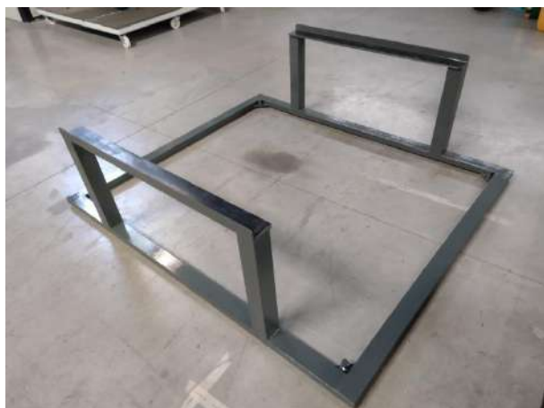
Bancada de asiento del cárter y detalle del método de nivelado para corregir las irregularidades del suelo Tamaño de la bancada del cárter: 200 x 174 x 67 cm
