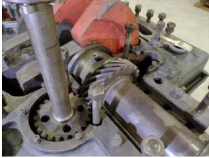
Al bajar el cigüeñal debemos cuidar que el engranaje con el árbol de levas sea correcto.
