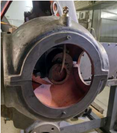
La salida del aceite para la biela del compresor, viene del circuito lateral de bombeo. Tapas para el engrase manual en los sombreretes
