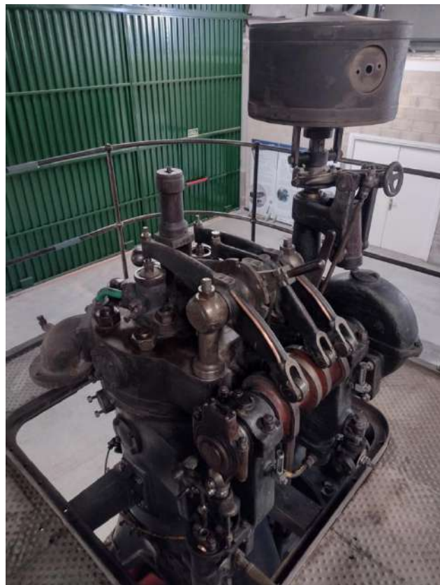
El árbol de levas es la parte más complicada en cuestión de mecánica. Al no plantearse la posibilidad de desmontarlo en parte, no podemos conocer los engranajes internos de la cámara superior
