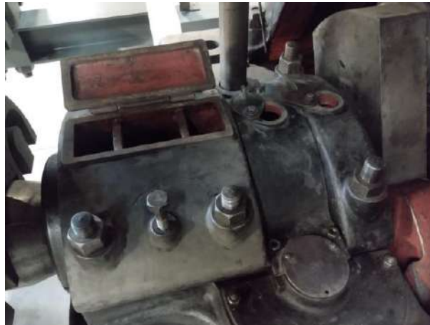
La salida del aceite para la biela del compresor, viene del circuito lateral de bombeo. Tapas para el engrase manual en los sombreretes
