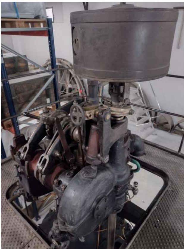
El árbol de levas es la parte más complicada en cuestión de mecánica. Al no plantearse la posibilidad de desmontarlo en parte, no podemos conocer los engranajes internos de la cámara superior
