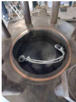
Aspectos de la biela principal, con los tornillos de anclaje para su manipulación. El cable de acero trenzado quedará en su interior por si fuera necesario desmontar el motor en un futuro.
