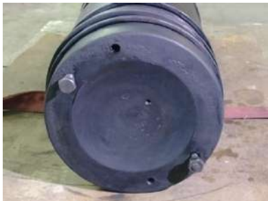
Aspectos de la biela principal, con los tornillos de anclaje para su manipulación. El cable de acero trenzado quedará en su interior por si fuera necesario desmontar el motor en un futuro.
