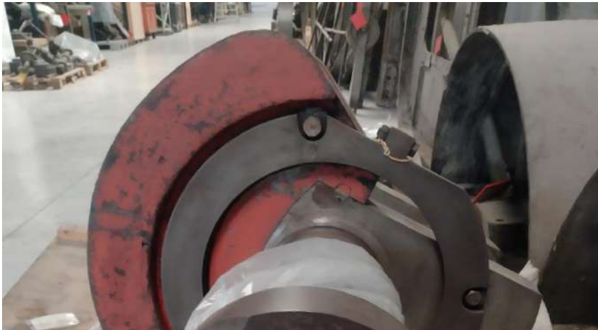
Anillo del cigüeñal que se combina con las dos piezas del cojinete C. Es necesario montar y asegurar los cojinetes al instalar el cigüeñal en la bañera de cárter.
