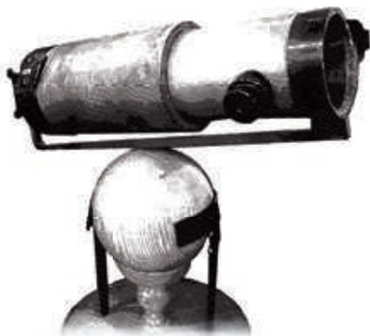
Segundo telescopio reflector de Newton, el cual fue presentado a la Royal Society en 1672.
