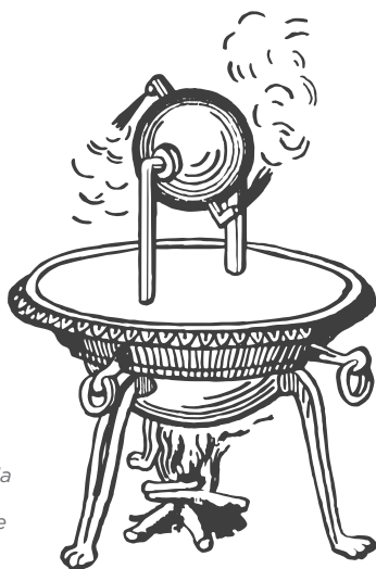
Ilustración de una eolípila de Herón. «Diccionario mecánico americano» de Knight, 1876.
